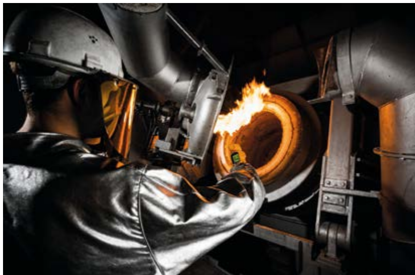
Foto: Temperaturmessung im pyrometallurgischen Top Blown Rotary Converter (TBRC). © RWTH Aachen University / Martin Braun.
